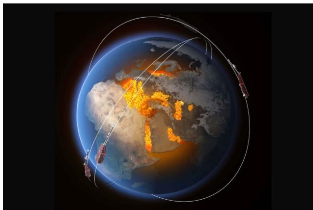
Рис. 1. Группировка спутников Swarm на орбите. Два космических аппарата летят параллельно друг другу, а третий – в иной азимутальной плоскости. Такая конфигурация позволяет обнаружить и измерить с высокой точностью магнитные сигналы, поступающие от различных источников: из внутренних и внешних слоёв земной коры, ядра Земли, от океанских течений, возмущений магнитосферы и ионосферы, связанных с солнечной активностью (Р.Лукьянова, 2014)
